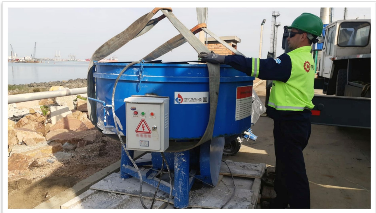
Mezcladora de eje horizontal intensiva de 12 bolsas de capacidad
